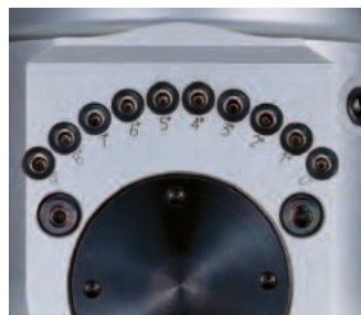
Einziger Einstellungsmechanismus ermöglicht es, dass der Spindelwinkel mit 1° - Schritten genau eingestellt werden kann.
