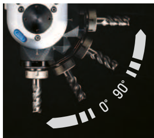
Kinderleicht einstellbarer Spindelwinkel von 0° bis 90°.
