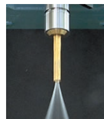
Kühlmittelfzufuhr durch das Zentrum
