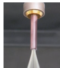
Kühlmittelzufuhr durch das Zentrum mit PS-Ring
